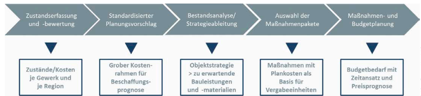
Im Rahmen der Instandhaltungsplanung mit epiqr entstehen Informationen, die dabei helfen, den Einkauf von Bauleistungen zu optimieren
