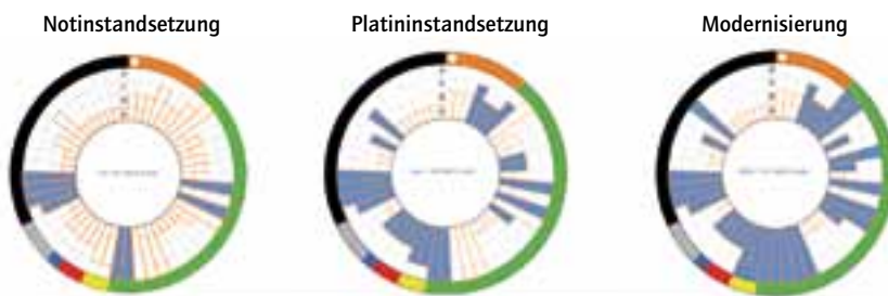
Ein Gebäude, drei Varianten: Für ein 1976 gebautes Wohnheim mit 3.222m 2 BGF wurden die Aufwände für drei verschiedene Instandhaltungsvarianten ermittelt und im epiqr-Diagramm dargestellt
